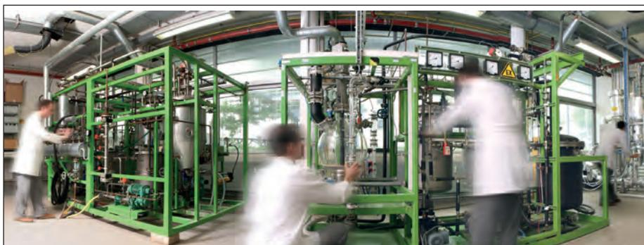
PPM betreibt eine in Deutschland einzigartige Versuchsanlage zur Gewinnung und Verarbeitung von Ölen und Proteinen aus nachwachsenden Rohstoffen im kleintechnischen Pilotmaßstab. Foto: PPM
